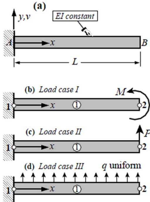
$$\text{Load case I: } v = \frac{Mx^2}{2EI}, \quad \theta = \frac{Mx}{EI}$$
