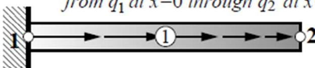
(d) Load case III:  $q(x)=q_0$  (constant) from  $x=0$  through  $x=L/2$ , else 0
