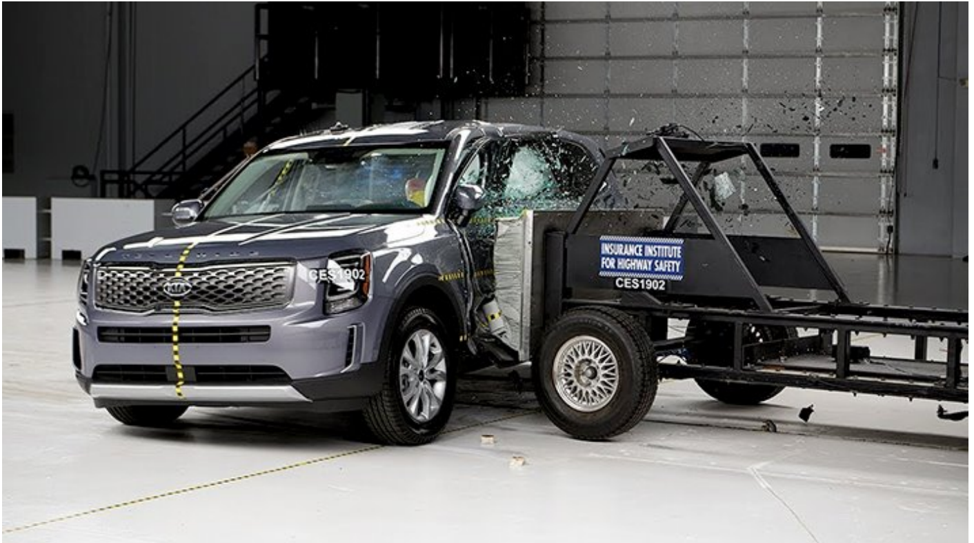
더미는 다양한 충돌 시험에 투입된다 (측면 충돌 테스트 장면)
