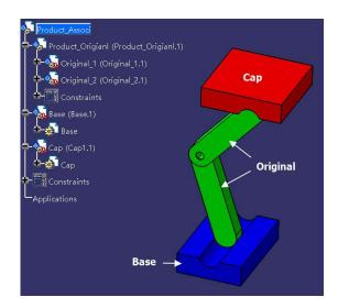
8. DMU Kinematics 에서 아래 Mechanism 을 구현하기 위한 방법을 두가지 이상 자세히 설명하고 그 때 필요한 Joint 의 종류를 서술하시오(기어비는 9:20). Hint. BELT 는 Mechanism 에 포함시키지 않는다. (12 pts)
