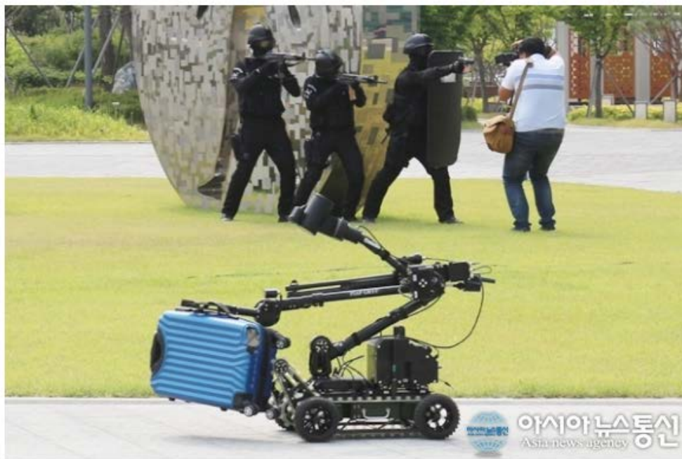
사진은 현재 우리 군의 폭발물 처리반이 운용하고 있는 폭발물 탐지/제거 로봇 '그리프(GRYP)' 로봇의 모습이다./아시아뉴스통신 DB
